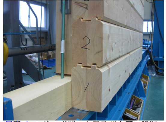
写真3 ログ-ログ間の水平及び上下の隙間(1.5m)
