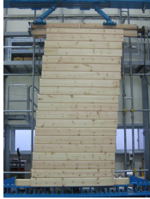
写真2 最大荷重時の全景(1.5m)
