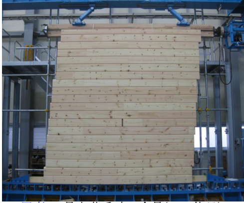
写真1 最大荷重時の全景(3m1 体目)
