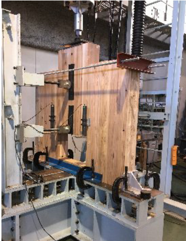
写真 2 スギのだぼ接合部のせん断の試験実施状況
