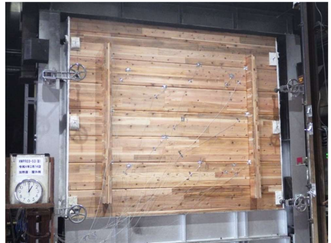
写真 1 試験終了時の非加熱面の状況
