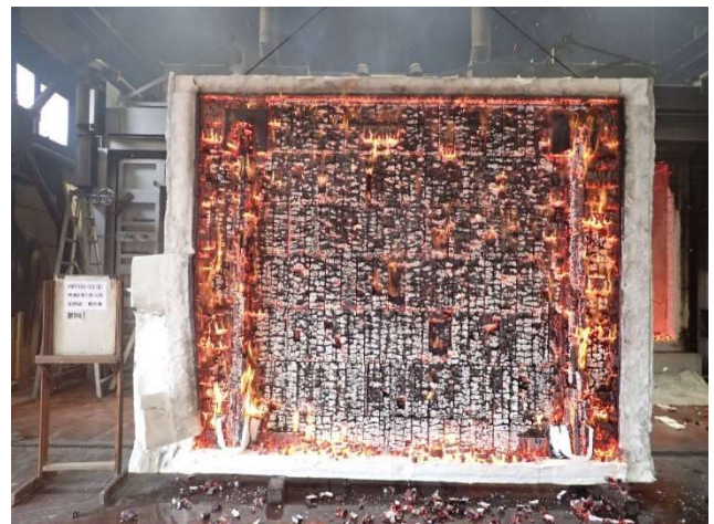
写真 2 脱炉後の加熱面の状況
